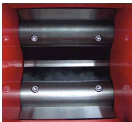
Mezera mezi ostřím štěpkovacích nožů je cca 0,1 mm. Štěpkovač proto přesekne i tenké větvičky.
