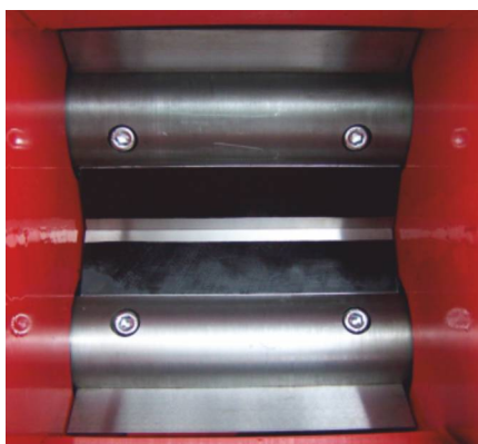
Mezera mezi ostřím štěpkovacích nožů je cca 0,1 mm. Štěpkovač proto přeseke i tenké větvičky.
