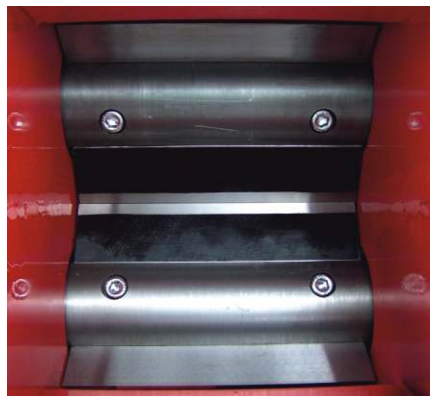
Der Spalt zwischen den Holzhammermessern beträgt etwa 0,1 mm. Der Holzschlägler trennt daher effektiv ebenso dünne Zweige.
